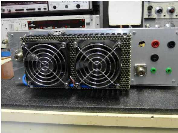
Ventilation du radiateur
