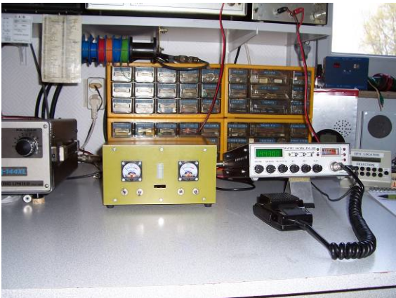
Réalisation ON4MFX Boitier en Circuit imprimé simple face
